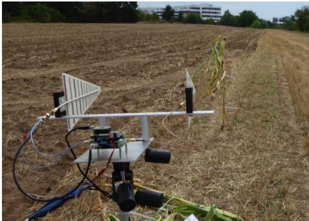
Abbildungen 12: Einzelne Pflanze auf dem Feld mit befestigten Fremdkörper in etwa 12 m Entfernung von den Radarantennen.
