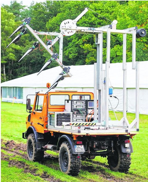
Abbildung 17: Kleinlaster mit sechs Radarantennen zur Minendetektion (Deutsches Zentrum für Luft- und Raumfahrt (DLR), 2016).
