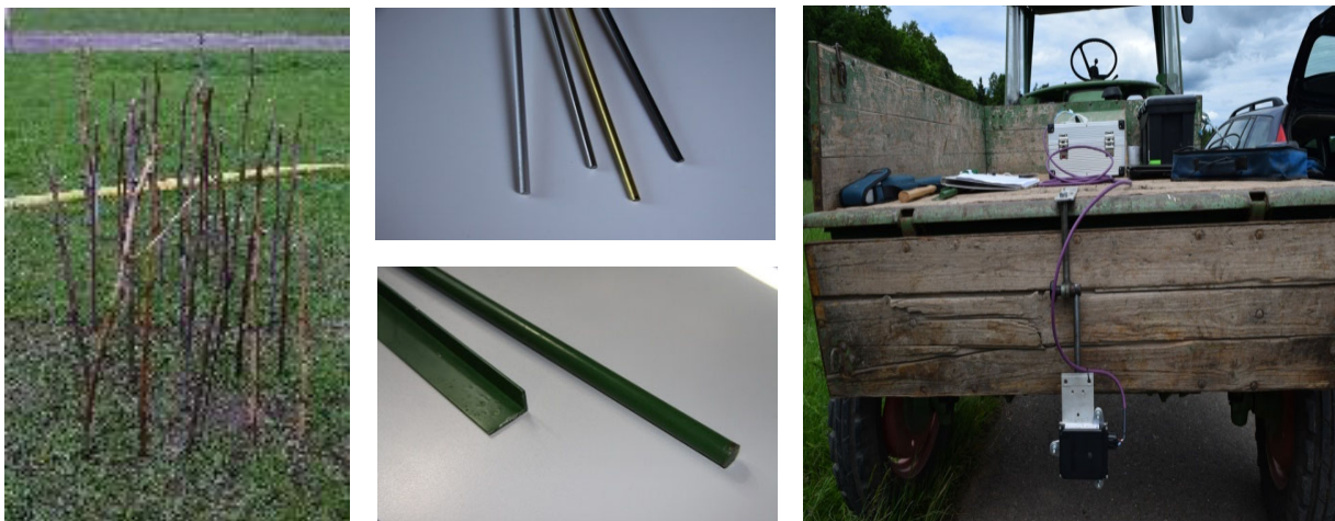
Abbildung 6: Von links nach rechts: Abgestorbener Spießknöterich; verwendete Fremdkörper aus Aluminium, Messing, Edelstahl und Stahl; Radarsensor SRR 208 von Continental befestigt an der Ladefläche eines Fendt GT (HSWT, 2016).
