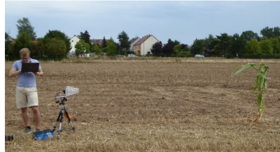
Abbildungen 12: Einzelne Pflanze auf dem Feld mit befestigten Fremdkörper in etwa 12 m Entfernung von den Radarantennen.
