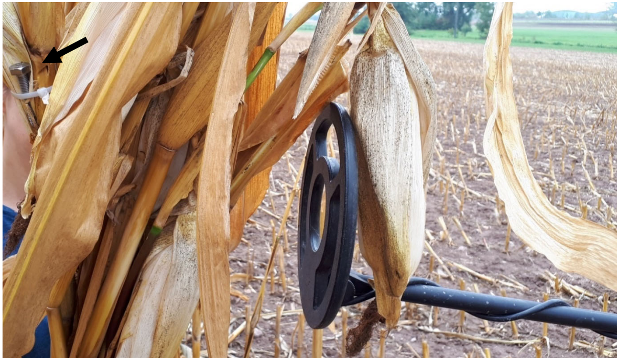
Abbildung 15: Erkennung der V2A-Schraube mittels Metalldetektor aus ca. 25 cm Entfernung.
